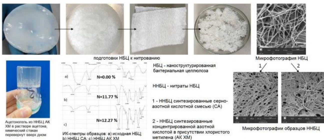
Схема первого этапа производства нитратов наноструктурированной бактериальной целлюлозы. Источник: Юлия Гисматулина
