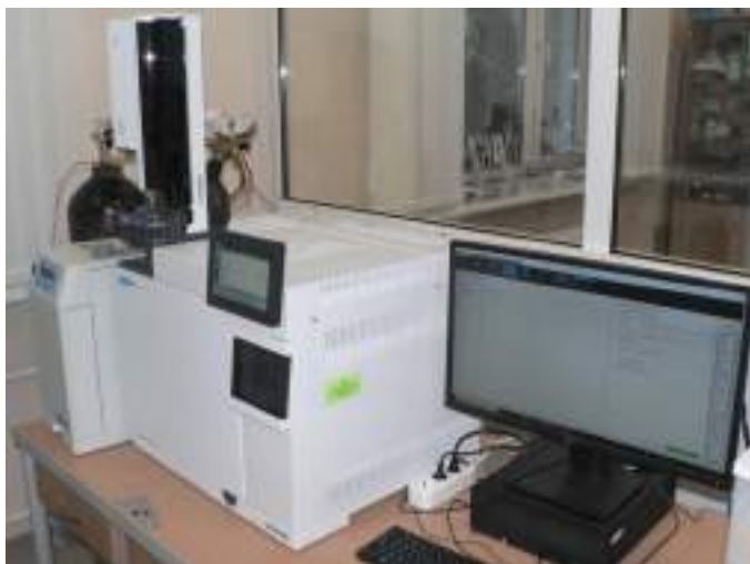
Рис. 7.2.1. Газовый хроматограф Agilent 8890 с электроно-захватным детектором Agilent под управлением программным обеспечением (ПО) Agilent OpenLab
