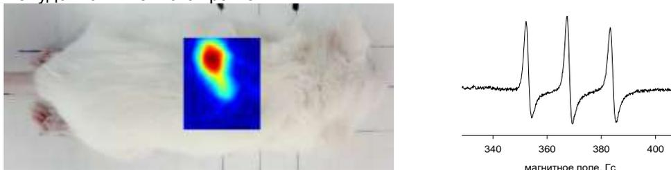
Рис. 5. 2D ЭПР томограмма, полученная после перорального введения 1 мл 30 мМ раствора радикала R1. Параметры записи томограммы: область наблюдения, 20x20 мм<sup>2</sup>, градиент поля, 6 Гс/см, кол-во проекций, 47, время сканирования 6 минут (слева). Спектр ЭПР, полученный в выделенном желудке мыши через 6 часов после введения радикала (справа).
