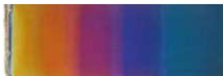
Рис. 11. Изменение цвета окрашивания образца анодированного алюминия в электролите осаждения металла (Co,Ni) от продолжительности анодирования в растворе серной кислоты и последующего анодирования при постоянном токе во втором электролите - растворе сульфосалициловой кислоты
