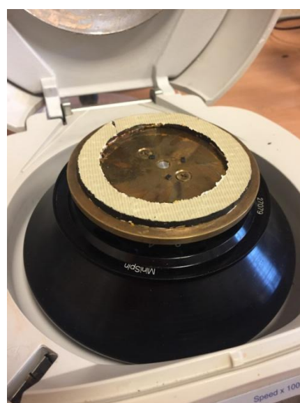
Рисунок п 5 Прибор Mini-spin модифицированной насадкой со специальной камерой для центрифугирования подложек.
