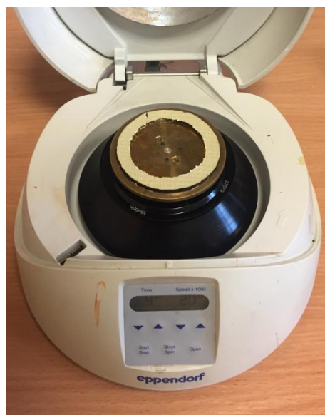
Рисунок п 5 Прибор Mini-spin модифицированной насадкой со специальной камерой для центрифугирования подложек.
